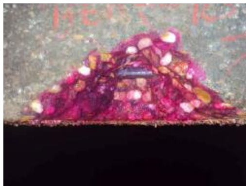
Foto 47- Detalhe da região após aplicação da fenolftaleína
