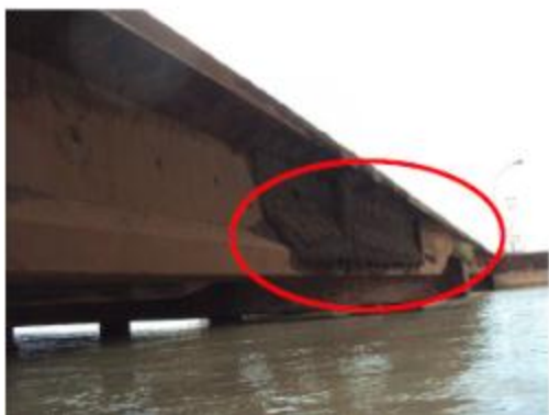
Foto 21– VL1-Incrustação dura na lateral
