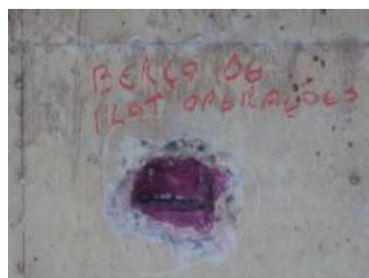
Foto 88- Detalhe da região após aplicação da fenolftaleína
