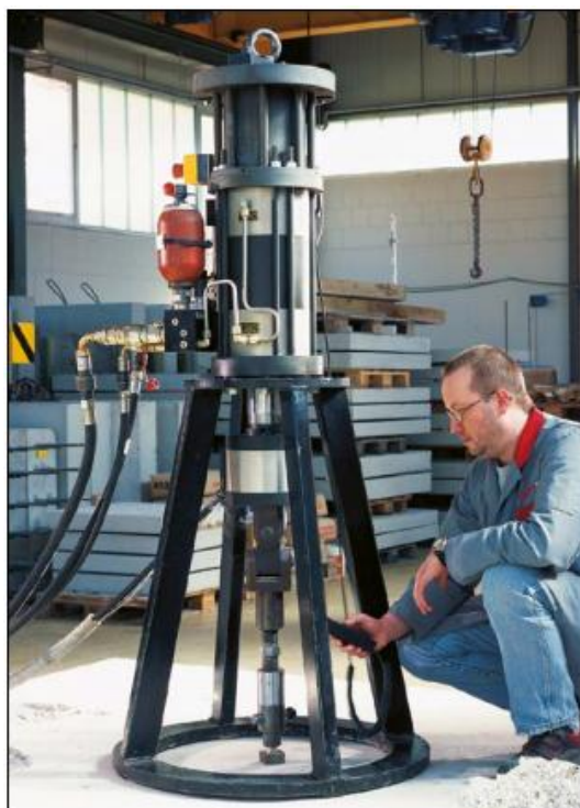
Figura 5.10 – Ensaio de Arrancamento de Ancoragem por Adesão Química.
