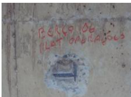
Foto 87- Detalhe da região preparada para a execução do ensaio
